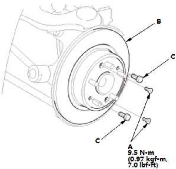
1. 拆下制动盘平头螺钉 (A)。
